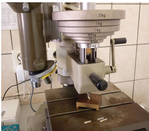
ABBILDUNG 11: Versuchsaufbau zur Bestimmung der Vickers-Härte
